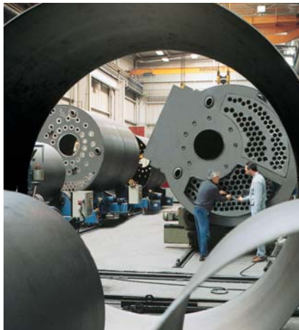
Vitomax Kessel in verschiedenen Bearbeitungsstadien
